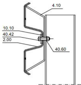
Pfostenverschraubung Profil B
