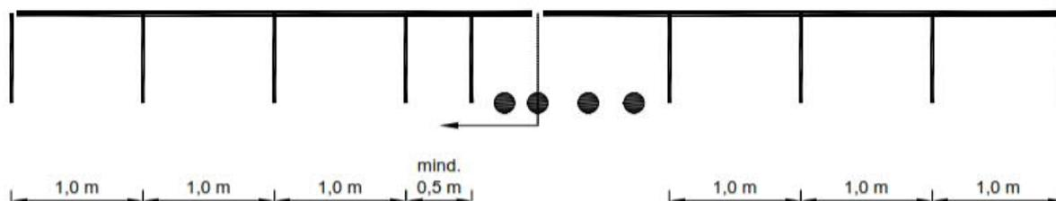
Würde auch der verschobene Pfosten dichter als 0,5 m zum nächst angrenzenden Pfosten angeordnet werden müssen, darf mit Genehmigung des Auftraggebers dieser Pfosten ebenfalls weggelassen werden, sodass eine Lücke von 2,0 m entsteht.
