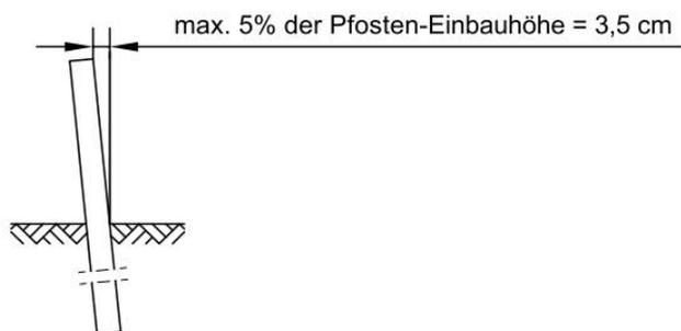
An Straßen mit sehr großem Längsgefälle, kann es vorkommen, dass der Winkel zwischen den Längselementen und den Pfosten zu stark von einem 90°-Winkel abweicht, sodass eine Montage nicht mehr möglich ist. In diesen Fällen können Pfosten in Längsrichtung konstruktionsbedingt abweichend von der lotrechten Montage gerammt werden. Eine senkrechte Ausrichtung ist dann zu empfehlen.
