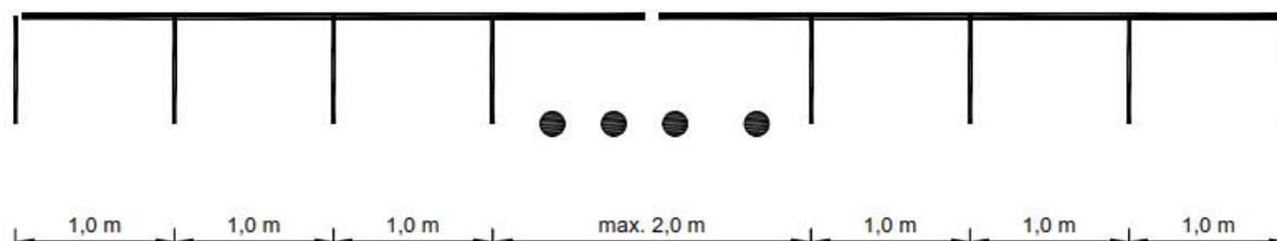
Ein größerer Pfostenabstand ist nicht zulässig. In diesem Fall sind Sondermaßnahmen in Absprache mit dem Auftraggeber zu treffen, wie z.B. einzelne Eingrabpfosten oder ein Streifenfundament.
