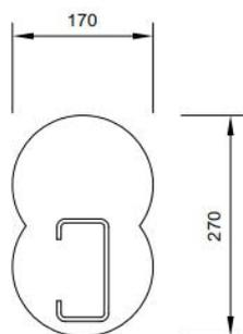
Erfolgt der Einbau in befestigten Oberflächen (z.B. Asphalt oder Pflasterfläche), muss gewährleistet sein, dass sich die Pfosten wie in unbefestigter Fläche bei einem Anprall bewegen können. Deshalb muss eine ausreichend große Aussparung in der befestigten Fläche hergestellt werden. Die Aussparung kann wahlweise rund oder rechteckig ausgeführt werden. Der Pfosten muss außermittig auf der Fahrbahn zugewandten Seite eingerammt werden.
