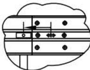
Kann ein Pfosten auch unter Ausnutzung der Toleranz von  $+ 30\text{ cm}$  nicht an der vorgesehenen Stelle eingerammt werden, muss der Pfosten entsprechend verschoben und ein zusätzlicher Pfosten gerammt werden.
