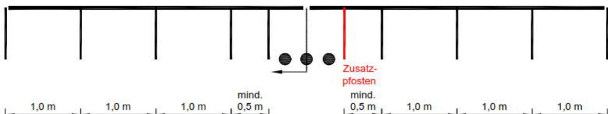
Ist der Schutzstreifen für die Kabeltrasse oder der Schacht so breit, dass der Abstand zu den angrenzenden Pfosten 0,50 m unterschreitet, kann ausnahmsweise der Zusatzpfosten weggelassen werden. Zuvor muss jedoch geprüft werden, ob eine regelkonforme Lösung oder ein verbessertes Schutzniveau möglich ist, wenn der angrenzende Pfosten ebenfalls verschoben wird.
